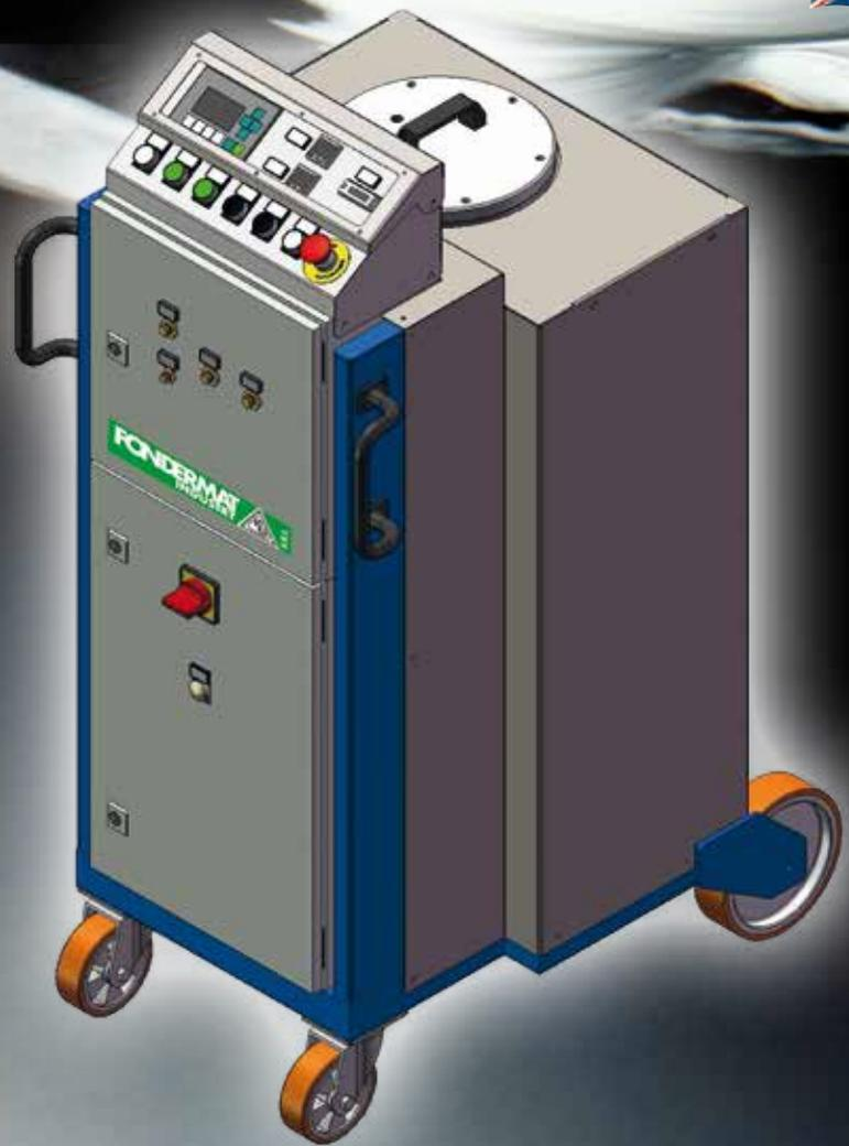
La necessità di trattare l'alluminio fuso all'interno di forni a bacino, ci ha spinto a realizzare una unità di insufflazione flussi sotto bagno a mezzo di gas inerte. Nasce così il **SIST DS**, una apparecchiatura di ridotte dimensioni, montata su una struttura carrellata, che ne consente un'agevole movimentazione in fonderia.
